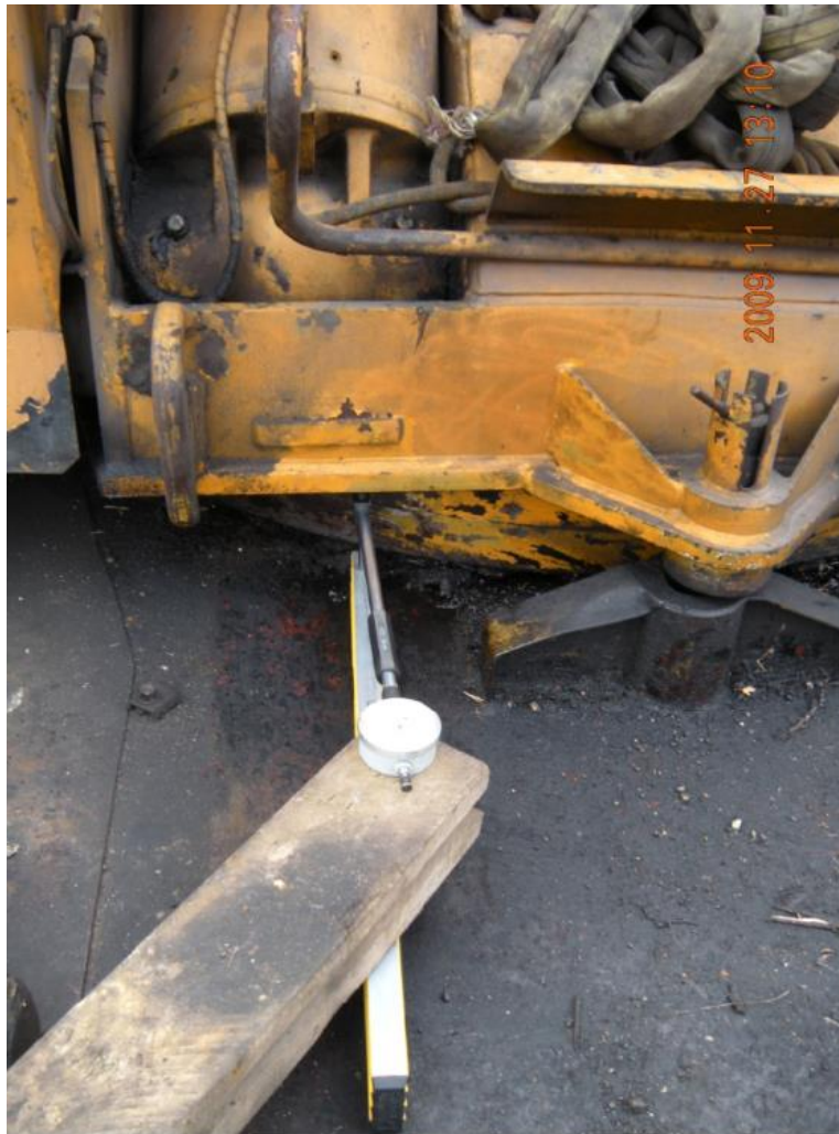
Koszorú billegés mérés nehezen hozzáférhető helyen furatmérővel
