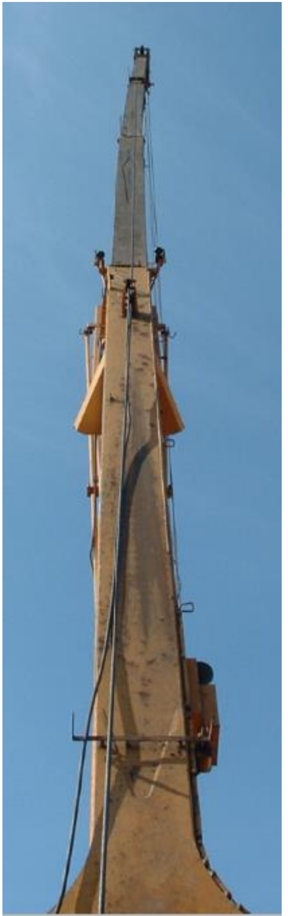
A gémszerkezet elhajlása utalhat szerkezeti sérülésre
