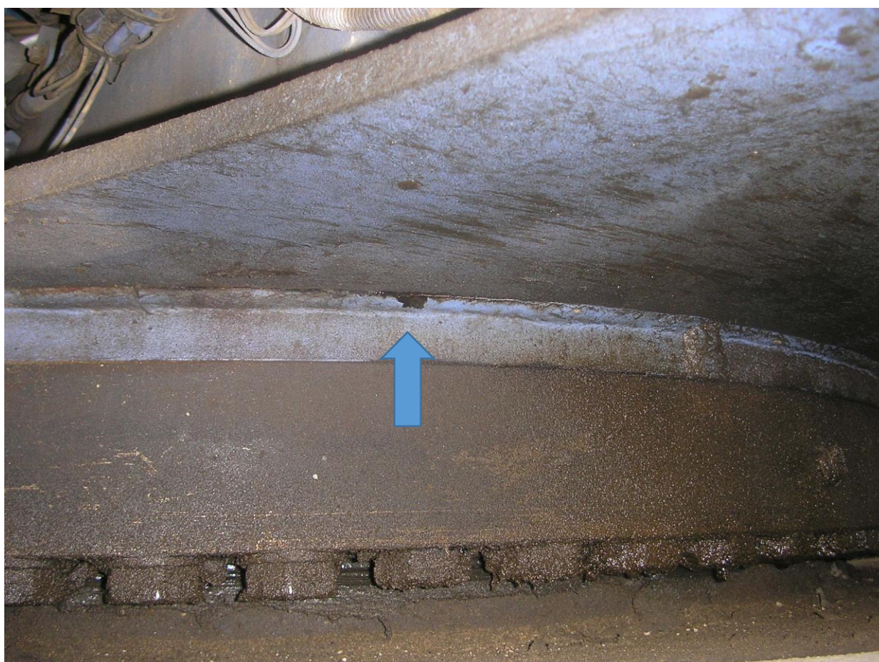
Koszorú lekötés körüli forgóasztal repedésre utaló olajfolt rendellenes helyen!
