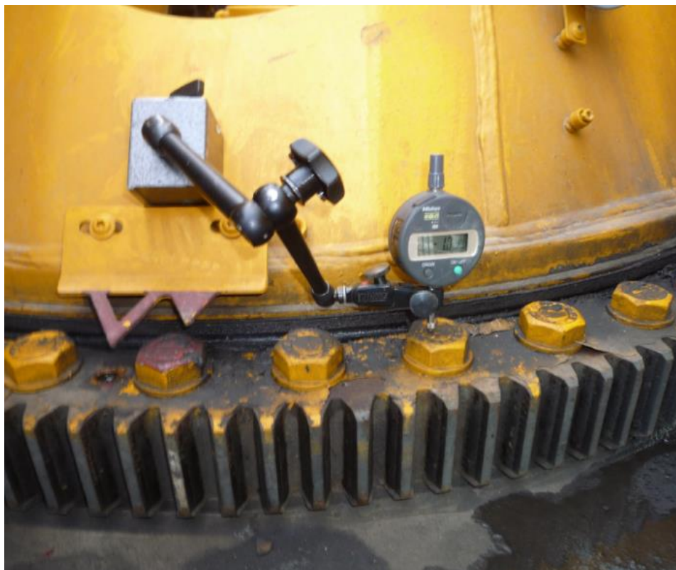
Koszorú billegés mérés hozzáférhető helyen
